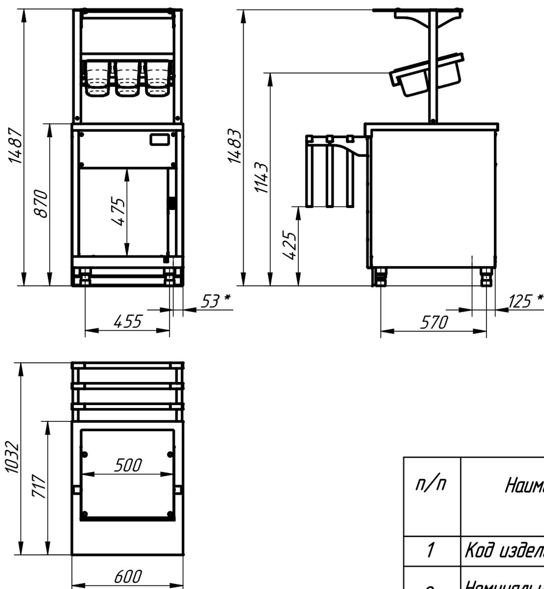
Прилавок столовых приборов, подносов и хлеба предназначен для раздачи потребителям столовых приборов и подносов в составе линии раздачи. Прилавок имеет шесть нержавеющей емкостей для столовых приборов. Над прилавком установлена полка для нарезанного хлеба. Полка оборудована лампой подсветки.
